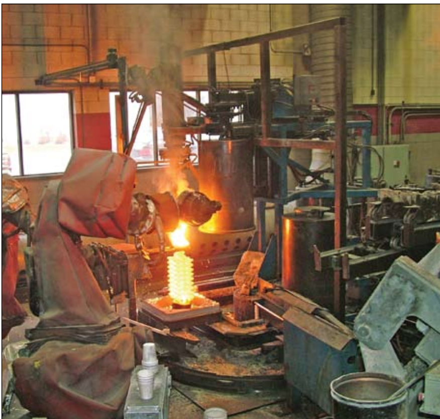
Robots pour molten metal into the molds.
